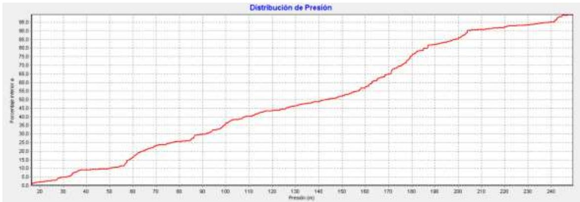
**Gráfica 6.**Distribución de la presión sin operación de válvulas en condiciones normales
